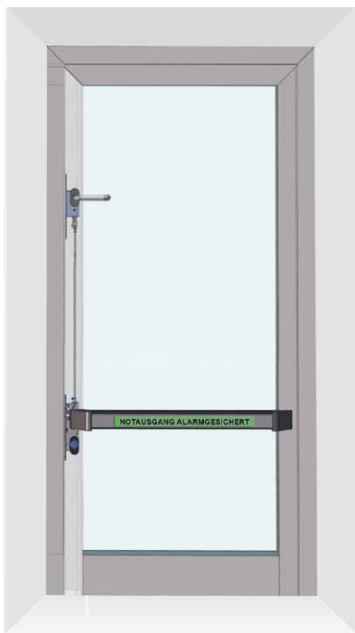
Prikaz s GfS e-Bar® na visini od 900 mm
